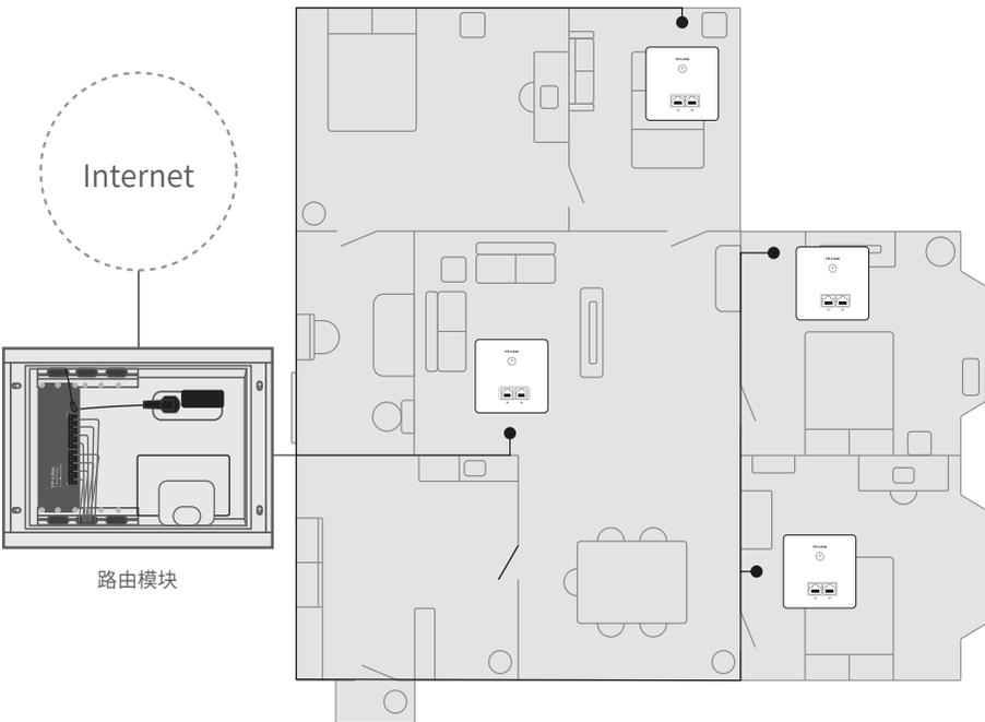
\* PoE·AC一体化千兆路由模块内置AC（无线控制器）和标准PoE供电功能,可统一管理20台TP-LINK AP产品,简化家庭无线组网复杂度。产品尺寸小巧,可部署于家庭信息箱/弱电箱。
